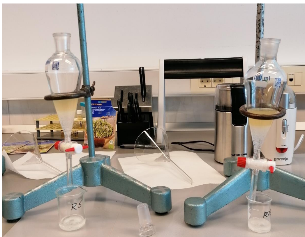
Slika 2.5. Ekstrakcija hlapljivih spojeva iz uzorka Eruca vesicaria
