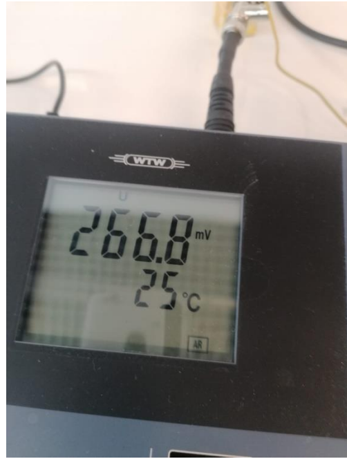
Slika 16. Potenciometrijsko mjerenje CPE, prikaz potencijala
