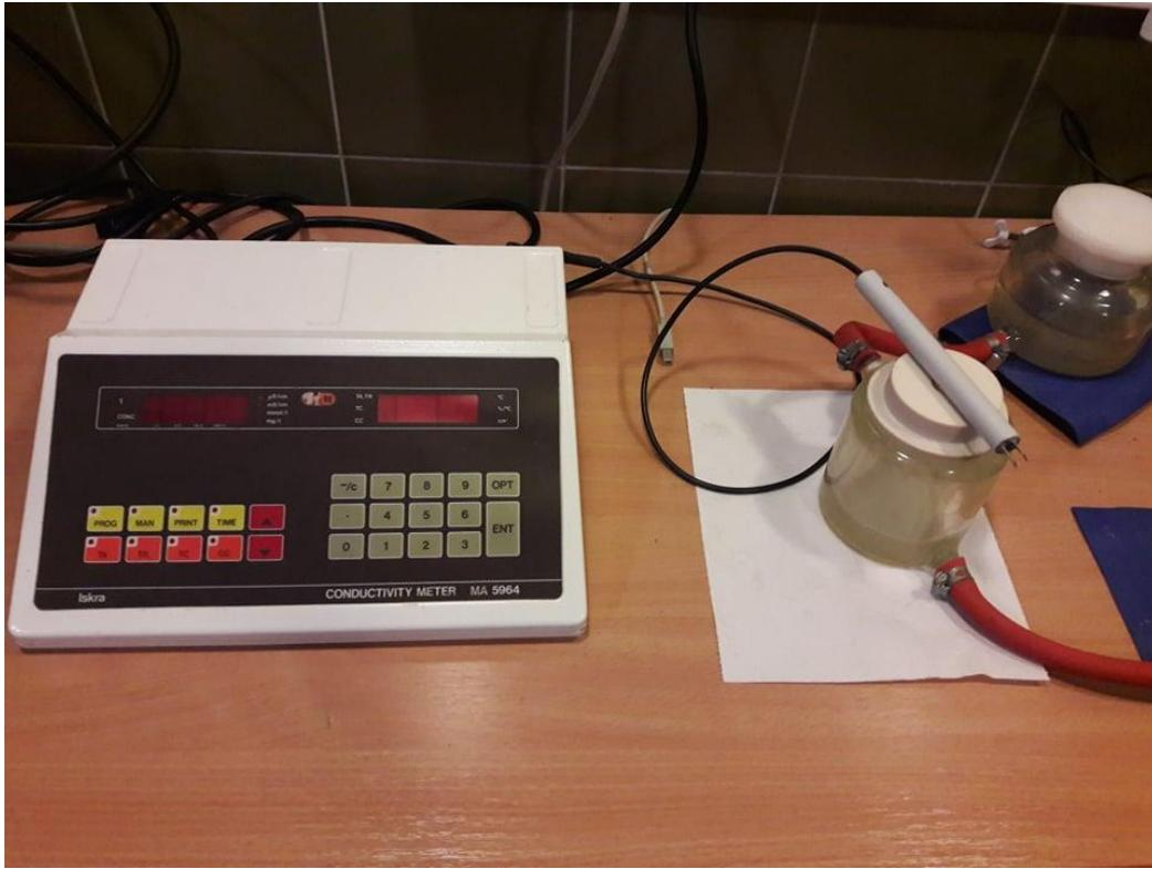
**Slika 8.** Aparatura za određivanje specifične provodnosti.
