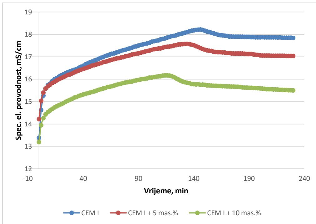
**Slika 9.** Ovisnost specifične električne provodnosti čistog portland cementa CEM I izmjerena pri  $20^{\circ}\text{C}$  i  $\text{V/C} = 0,5$ , te uz 5 mas.% i 10 mas.% prirodnog MgO o vremenu hidratacije.
