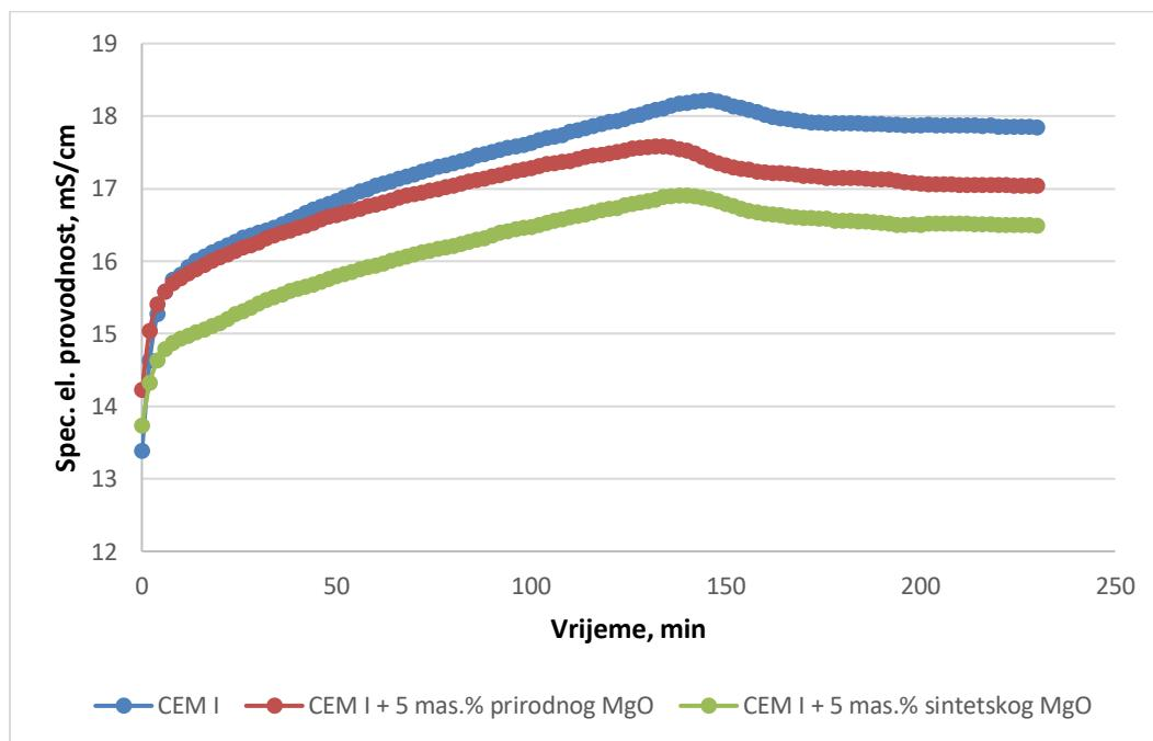
**Slika 11.** Ovisnost specifične električne provodnosti čistog portland cementa CEM I izmjerena pri  $20^{\circ}\text{C}$  i  $\text{V/C} = 0,5$ , te uz 5 mas.% prirodnog i sintetskog  $\text{MgO}$  o vremenu hidratacije.
