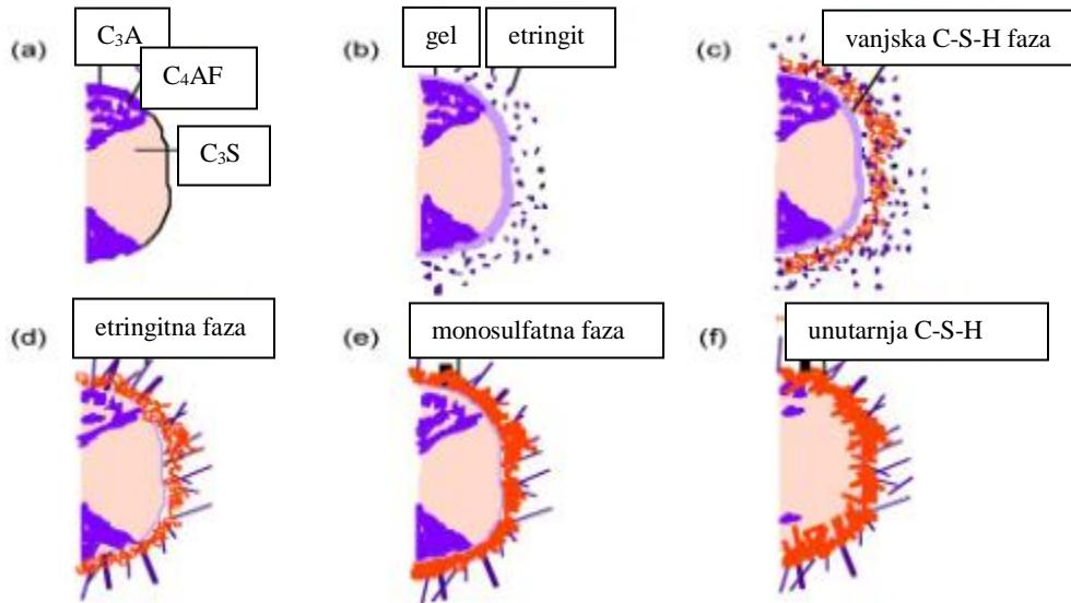
**Slika 3.** Shema hidratacije cementa: a) nehidratizirani cement, b) hidratizirani cement nakon 10 minuta, c) nakon 10 sati, d) nakon 18 sati, e) nakon 1 – 3 dana, f) nakon dva tjedna.<sup>13</sup>
