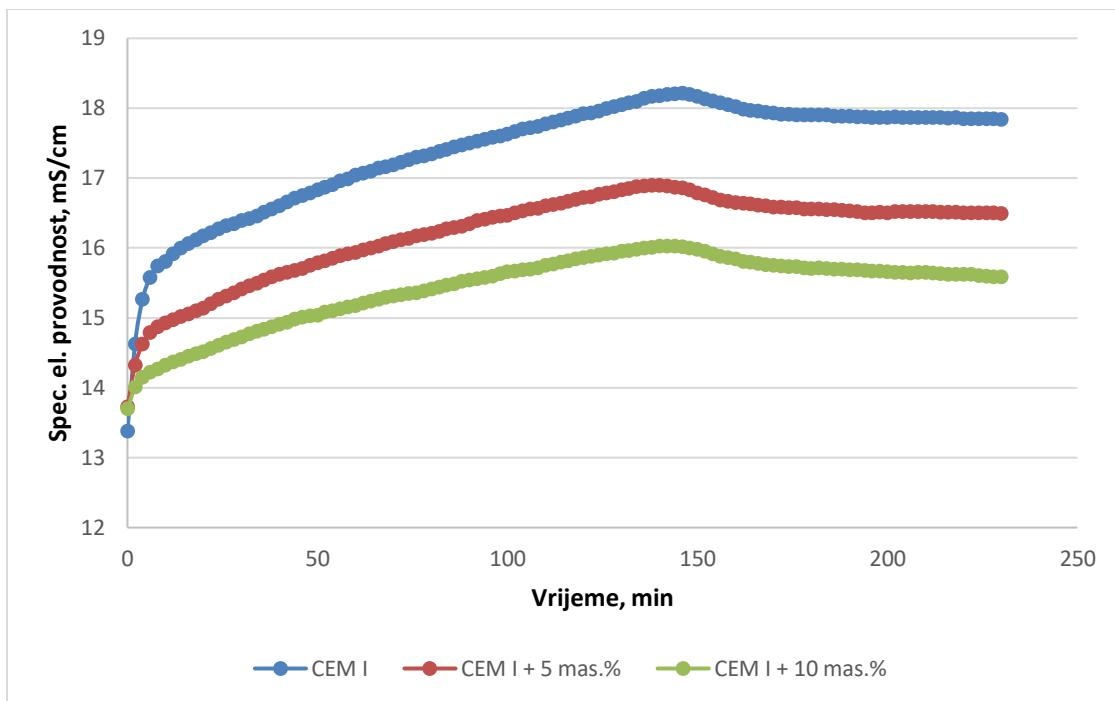
**Slika 10.** Ovisnost specifične električne provodnosti čistog portland cementa CEM I izmjerena pri  $20^{\circ}\text{C}$  i  $\text{V/C} = 0,5$ , te uz 5 mas.% i 10 mas.% sintetskog  $\text{MgO}$  o vremenu hidratacije.
