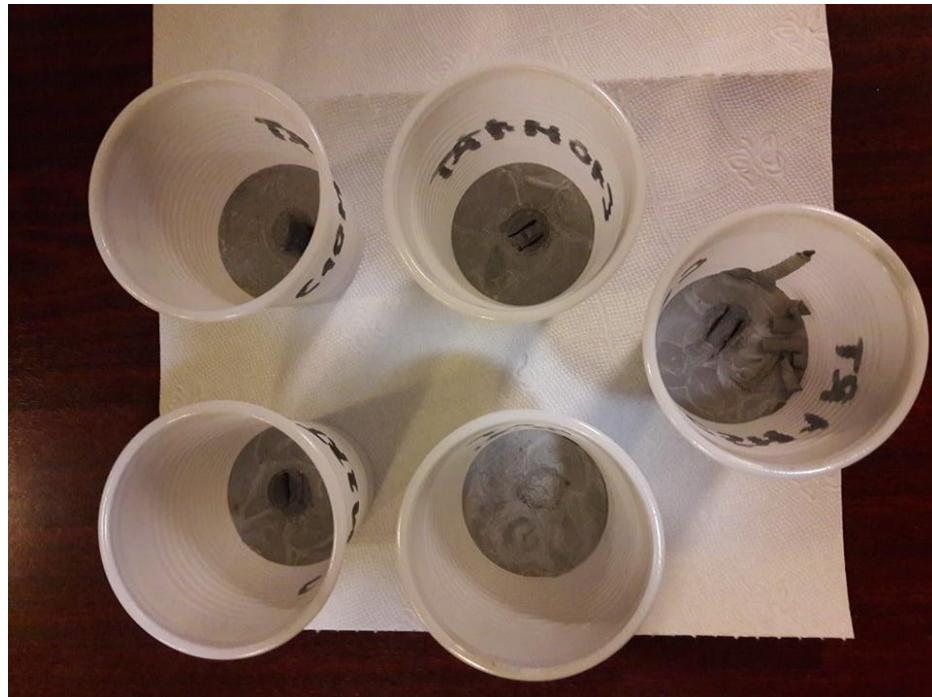
**Slika 7.** Uzorci cementne paste s različitim dodatkom MgO.
