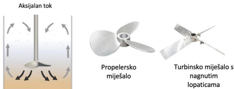
Slika 14. Prikaz aksijalnog toka, te tipovi miješala koji se koriste pri suspendiranju 23,24 .
