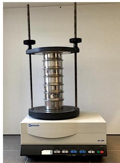
**Slika 27.** Aparatura za određivanje granulometrijske analize prosijavanjem.
