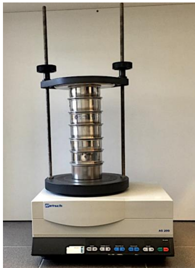
Slika 27. Aparatura za određivanje granulometrijske analize prosijavanjem.
