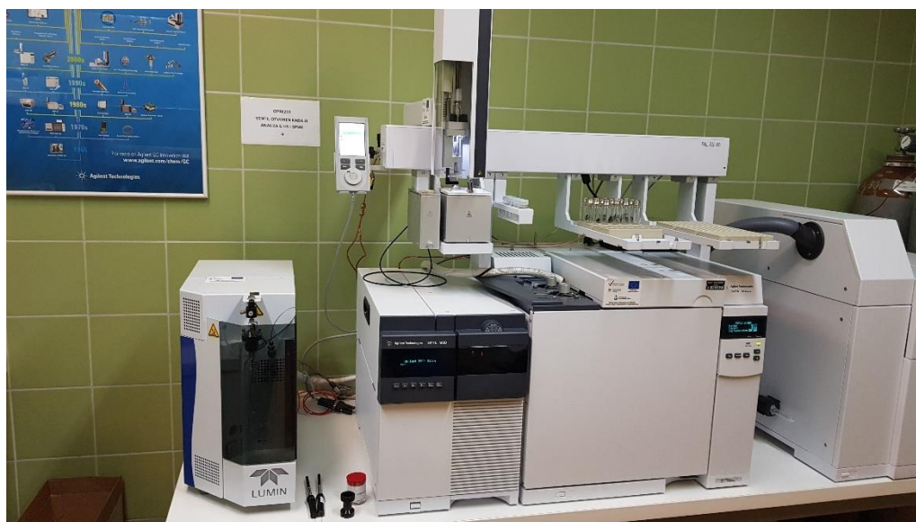
Slika 16. Vezani sustav plinska kromatografija-spektrometrija masa u Zavodu za organsku kemiju KTF-a (GC-MS)
