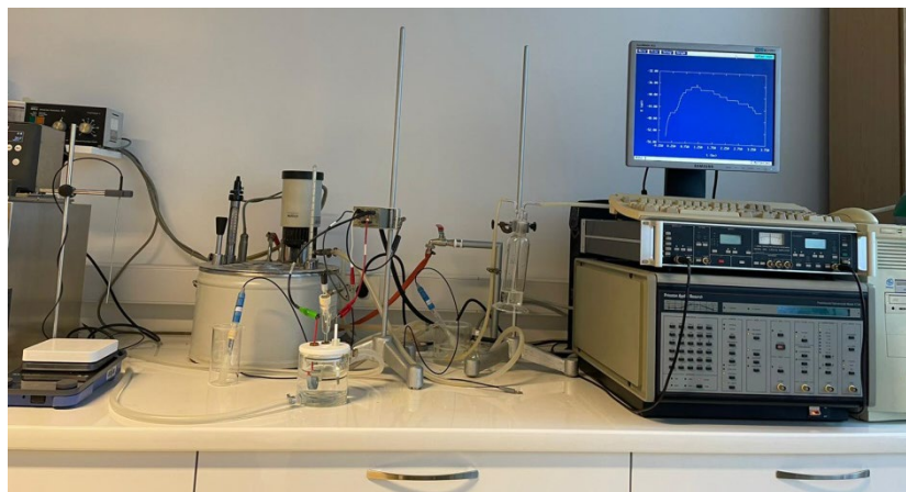
Slika 20. Aparatura za provedbu elektrokemijskih mjerenja
