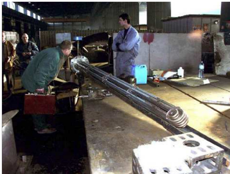
Slika 8. Izmjenjivač s plutajućom glavom 10
