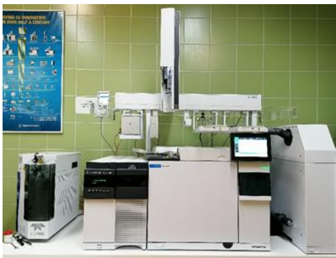
Slika 32. Vezani sustav plinska kromatografija-spektrometrija masa (GC-MS) u Zavodu za organsku kemiju Kemijsko-tehnološkog fakulteta u Splitu
