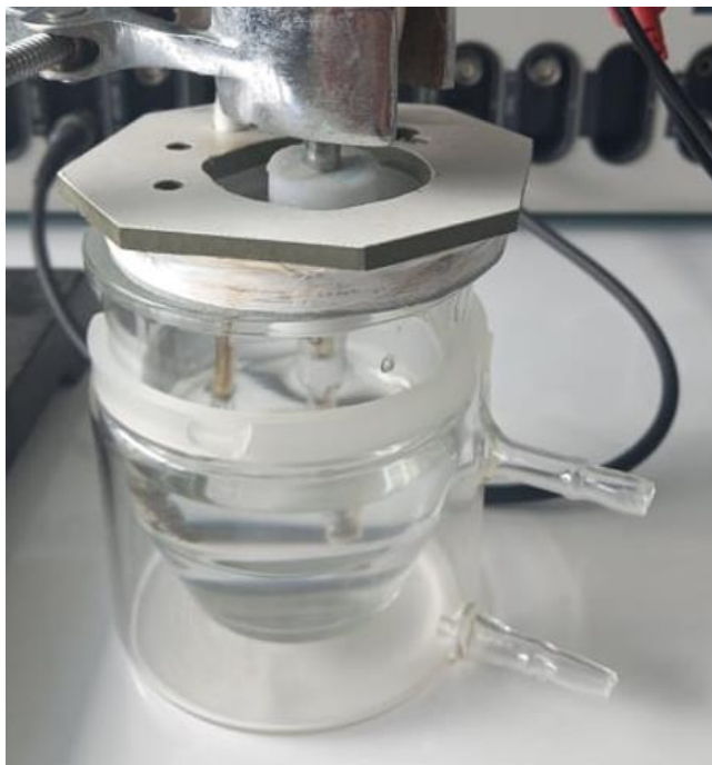
Slika 48. Prikaz elektrokemijske ćelije
