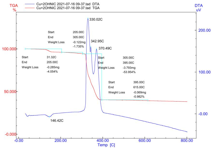
*Slika 11.* DTA i TGA krivulje za  $[\text{Cu}(2-\text{OHnic})_2(\text{H}_2\text{O})_2]$  za  $\text{pH} = 6$
