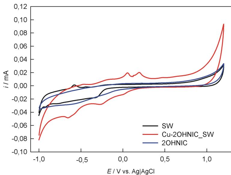
**Slika 64.** Ciklički voltamogrami snimljeni na **GC|SWCNT** i **GC|SWCNT|Cu–2OHnic** elektrodama u 0,1 M KNO<sub>3</sub> te uz dodatak 6–OHnic u otopinu ( $1 \times 10^{-4}$  M) **GC|SWCNT + 2OHnic**, brzinom promjene potencijala,  $v = 10$  mV/s
