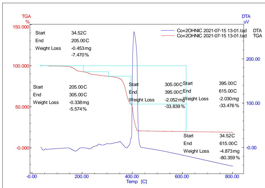
Slika 8. DTA i TGA krivulje za  $[\text{Co}(2-\text{OHnic})_2(\text{H}_2\text{O})_2]$
