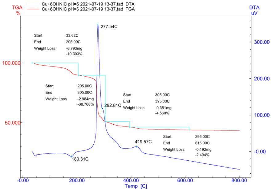
*Slika 12.* DTA i TGA krivulje za  $[\text{Cu}(6-\text{OHnic})_2(\text{H}_2\text{O})_2]$  za  $\text{pH} = 6$
