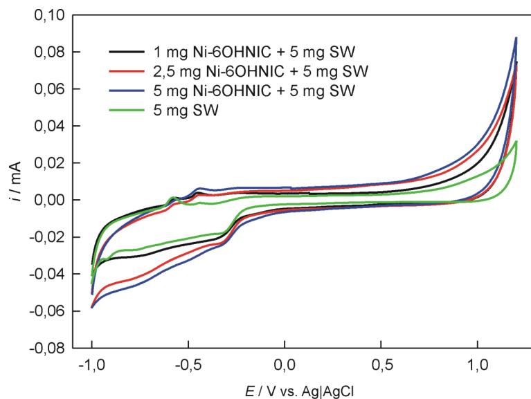
**Slika 63.** Ciklički voltamografi snimljeni na GC|SWCNT| elektrodi i GC|SWCNT|Ni–6OHnic elektrodama sa račičitim udjelima Ni–6OHnic kompleksa u SWCNT:Ni–6OHnic suspenzijama u 0,1 M KNO<sub>3</sub> brzinom promjene potencijala,  $v = 10$  mV/s.
