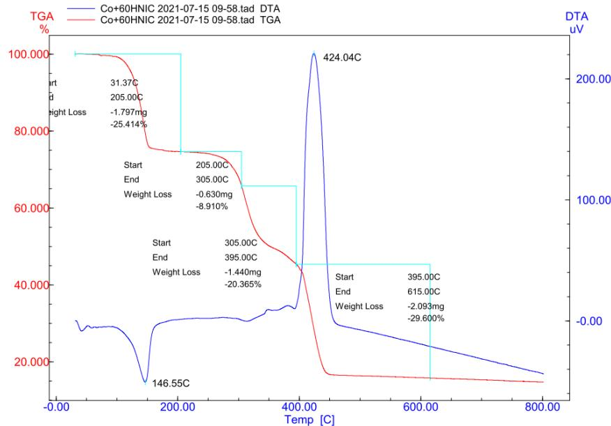
Slika 9. DTA i TGA krivulje za  $[\text{Co}(\text{H}_2\text{O})_6](6-\text{OHnic})_2$
