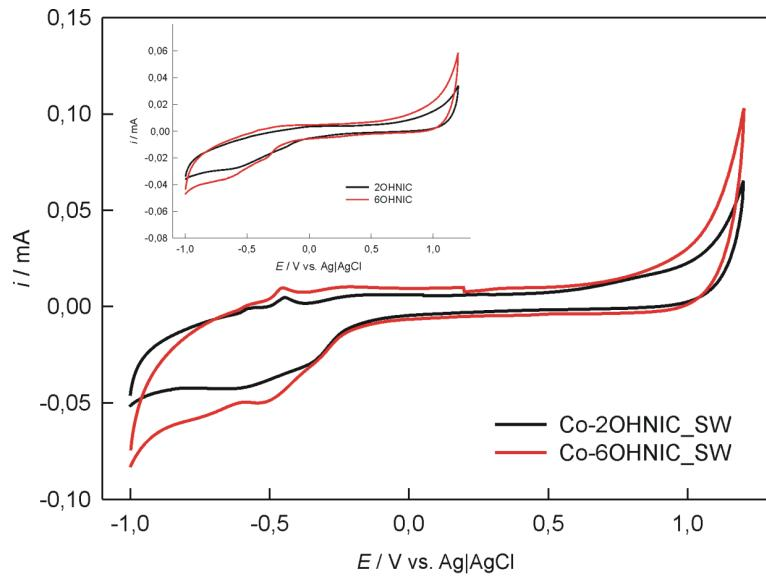
**Slika 61.** Ciklički voltamogrami snimljeni na GC|SWCNT|Co–2OH(6OH)nic elektrodama u 0,1 M KNO<sub>3</sub>, brzinom promjene potencijala, v = 10 mV/s. Insert ciklički voltamogrami snimljeni na GC|SWCNT| elektrodi u 0,1 M KNO<sub>3</sub> uz dodatak 2–OHnic (6–OHnic) u otopinu ( $1 \times 10^{-4}$  M), brzinom promjene potencijala, v = 10 mV/s.
