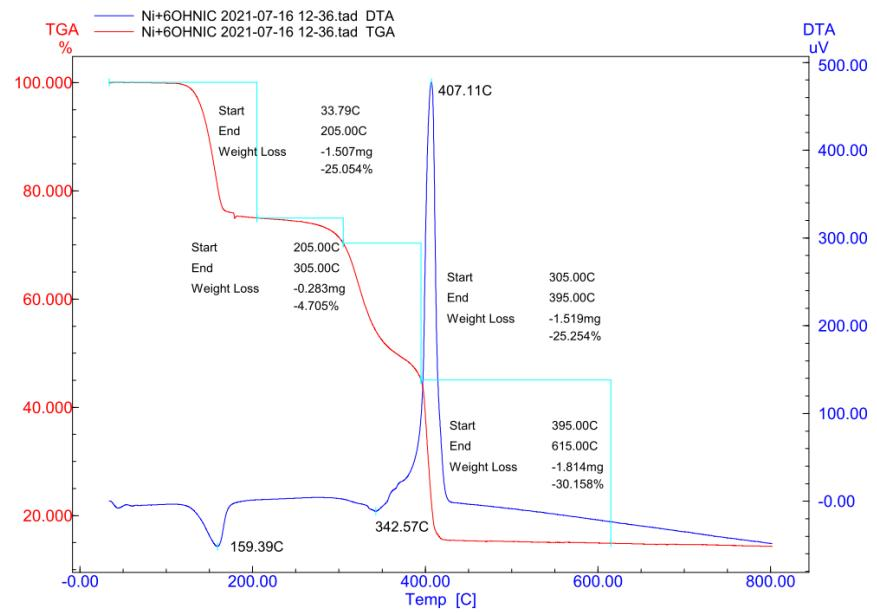
*Slika 10.* DTA i TGA krivulje za  $[\text{Ni}(\text{H}_2\text{O})_6](6-\text{OHnic})_2$
