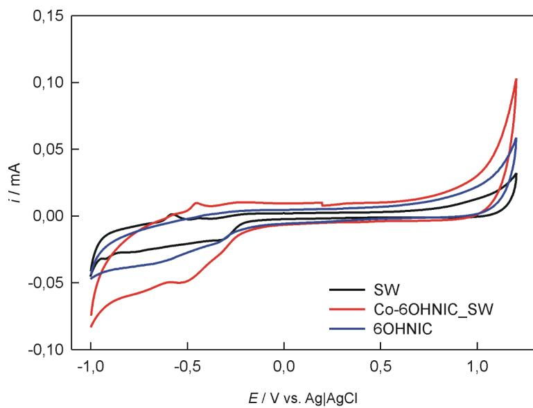
**Slika 60.** Ciklički voltamogrami snimljeni na **GC|SWCNT|** i **GC|SWCNT|Co-6OHnic** elektrodama u  $0,1 \text{ M KNO}_3$  te uz dodatak 6–OHnic u otopinu ( $1 \times 10^{-4} \text{ M}$ ) **GC|SWCNT + 6OHnic**, brzinom promjene potencijala,  $v = 10 \text{ mV/s}$
