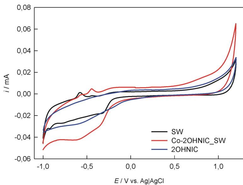
**Slika 59.** Ciklički voltamogrami snimljeni na **GC|SWCNT|** i **GC|SWCNT|Co–2OHnic** elektrodama u  $0,1\text{ M KNO}_3$  te uz dodatak  $2-\text{OHnic}$  u otopinu ( $1\times 10^{-4}\text{ M}$ ) **GC|SWCNT + 2OHnic**, brzinom promjene potencijala,  $v = 10\text{ mV/s}$
