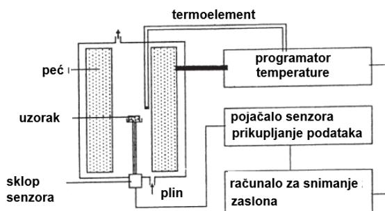
Slika 38. Shematski prikaz sustava za termičku analizu<sup>35</sup>
