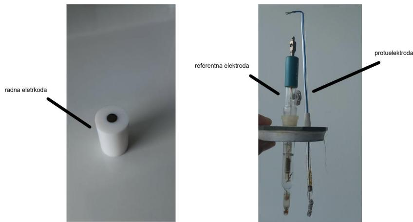
**Slika 49.** Prikaz radne elektrode, referentne elektrode i protuelektrode
