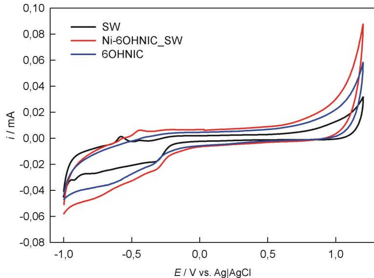
**Slika 62.** Ciklički voltamogrami snimljeni na GC|SWCNT| i GC|SWCNT|Ni–6OHnic elektrodama u 0,1 M KNO<sub>3</sub> te uz dodatak 6–OHnic u otopinu ( $1 \times 10^{-4}$  M) GC|SWCNT| + 6OHnic, brzinom promjene potencijala, v = 10 mV/s
