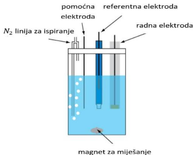
*Slika 35.* Prikaz elektrokemijske ćelije za voltametrijska mjerena<sup>32</sup>
