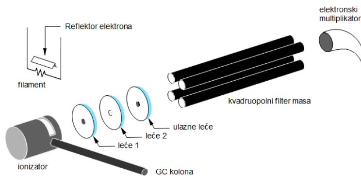
Slika 1.4. Shema masenog spektrometra s kvadropolnim filterom (3).
