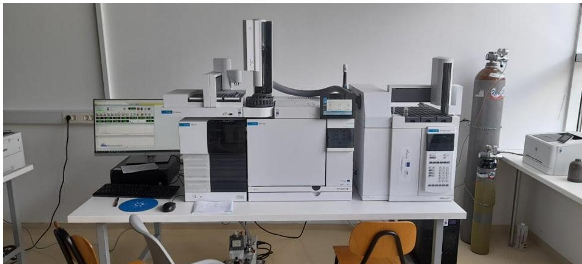
**Slika 2.6.** Fotografija korištenog GC-MS spregnutog sustava.
