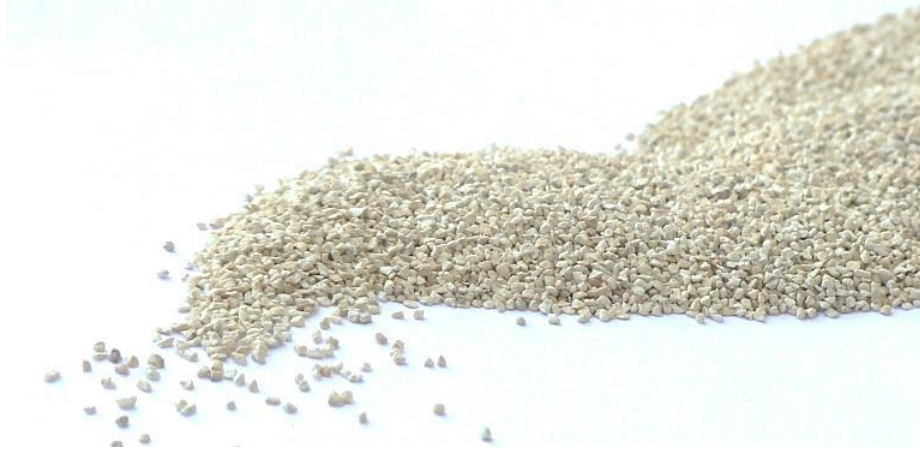
Slika 2.1. Prirodni zeolit klinoptilolit veličine čestica 0,6 - 0,8 mm.
