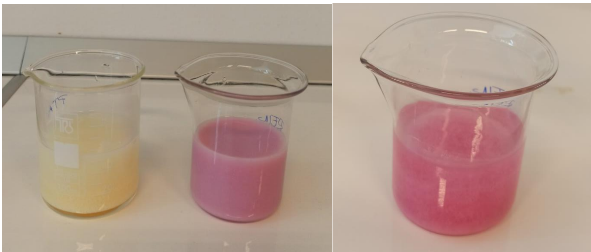
Slika 13. Taloženje MAP-a sa PTA, Reinekeovom soli i molibdatom
