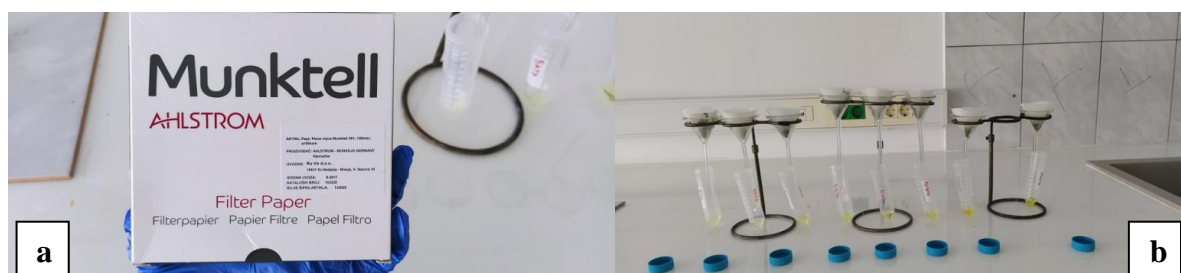
Slika 2.10. a) Korišteni filter papir; b) Filtracija uzoraka nakon spaljivanja
