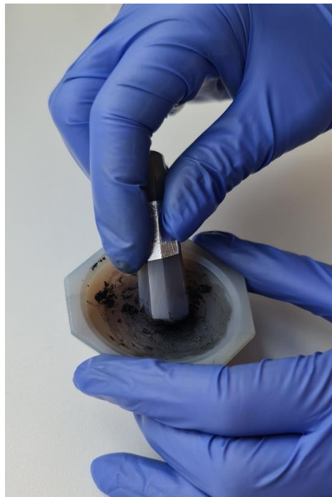
Slika 15. Priprema membrane u tarioniku
