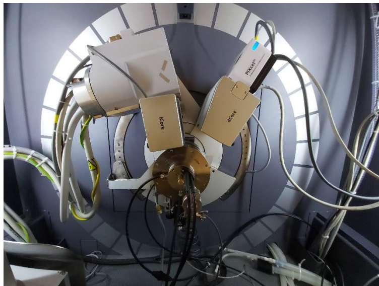
Slika 7. Difraktometar s instaliranom visoko temperaturnom komorom HTK 1200N, Anton Paar
