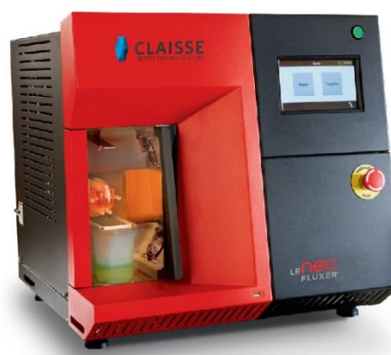
Slika 5. Postupak pripreve taljenih pastila za XRF analizu
