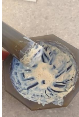
Slika 22. Pripremljena pasta nanokristaličnog praha ZnO s kiselinom
