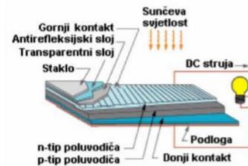
Slika 4. Spajanje PN spoja vanjskim strujnim krugom 13
