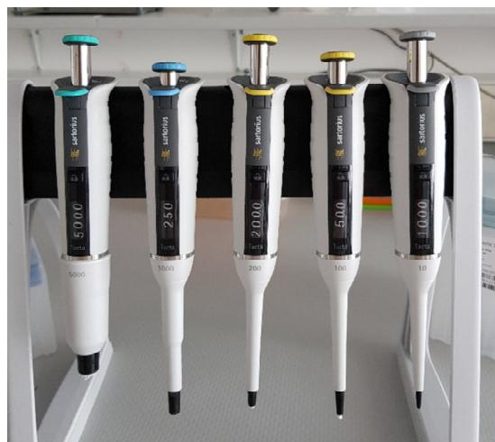
**Slika 8.** Tacta mehaničke pipete - (Sartorius, Njemačka)
