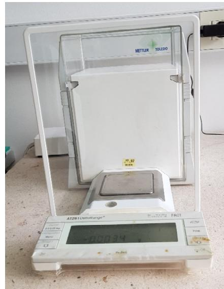
**Slika 7.** Analitička vaga - AT261 DeltaRange (Mettler Toledo, Švicarska)
