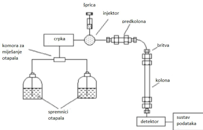
**Slika 4.** Shematski prikaz HPLC uređaja<sup>[13]</sup>
