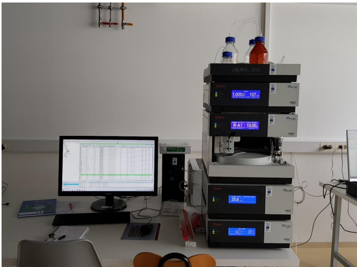
Slika 9. HPLC-DAD uređaj – Ultimate 3000 (Thermo Scientific, SAD)
