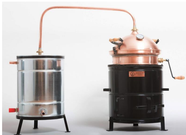
Slika 10. Jednostavni uređaj za destilaciju (29)
