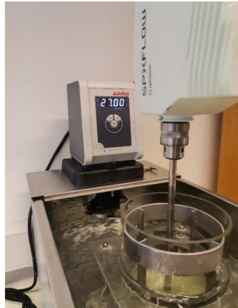
Slika 10. Šaržni reaktor uronjen u termostatiranu kupelj
