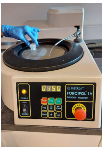
Slika 2.5. Mehanička obrada Sn na uređaju za brušenje i poliranje Metkon Forcipol 1V
