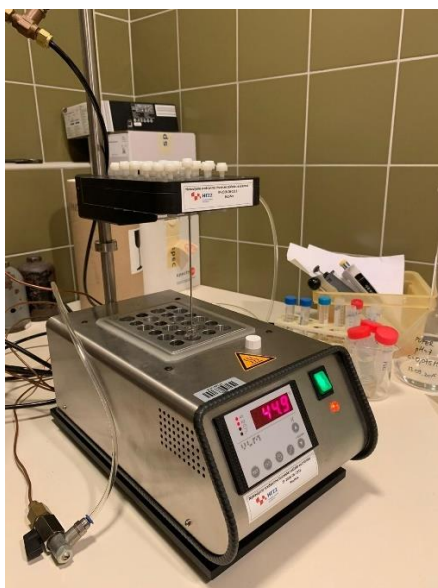
Slika 10. Uređaj za uparavanje uzoraka EC-1V-130 (VLM, Njemačka)
