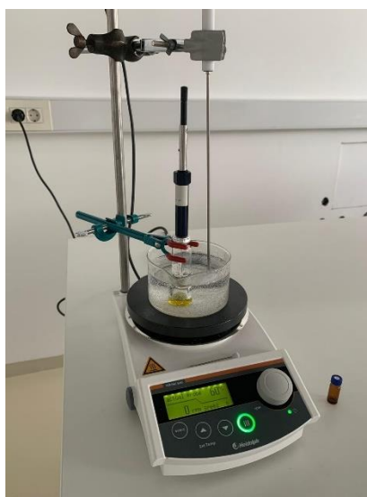
Slika 13. Aparatura za adsorpciju uzorka na sivo vlakno
