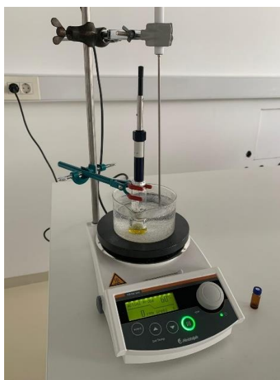
Slika 13. Aparatura za adsorpciju uzorka na sivo vlakno
