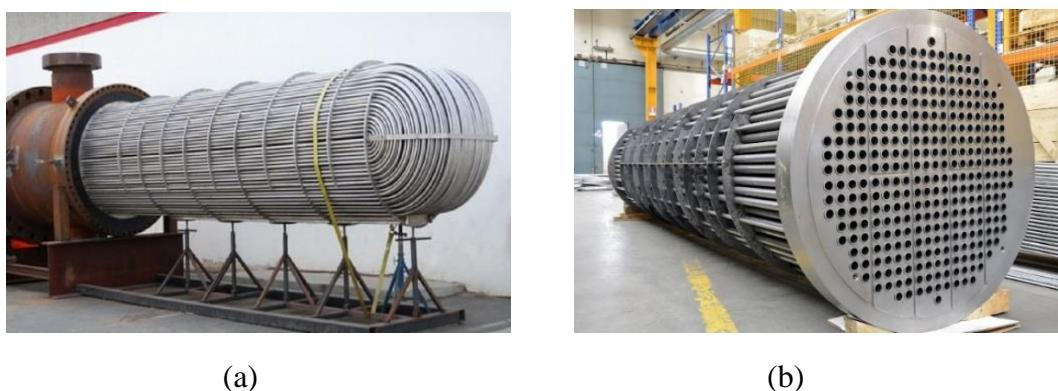
**Slika 1.6.** U–cijevni izmjenjivač<sup>16</sup> (a) i izmjenjivač topline s učvršćenim snopom cijevi<sup>17</sup> (b)
