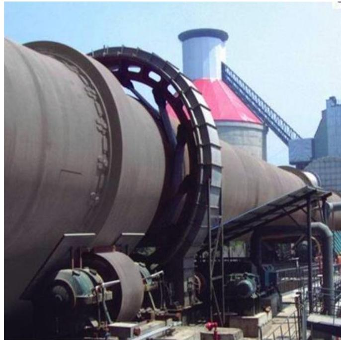
**Slika 1.3.** Klizni ležajevi rotacijske peći<sup>5</sup>
