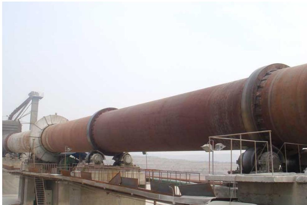
**Slika 1.2.** Rotacijska peć za proizvodnju cementa<sup>2</sup>
