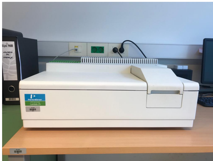
Slika 18. Perkin Elmer Lambda 25 UV/Vis spektrofotometar
