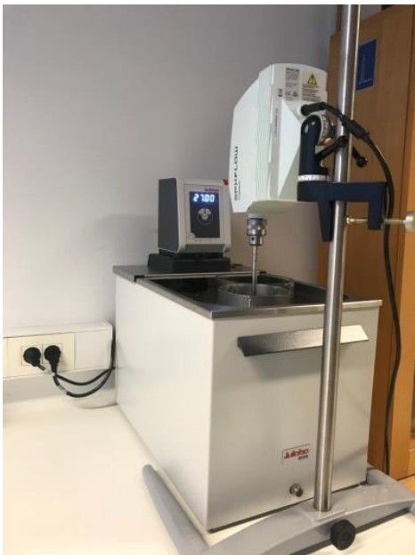
Slika 16. Kotlasti reaktor u termostatiranoj kupelji
