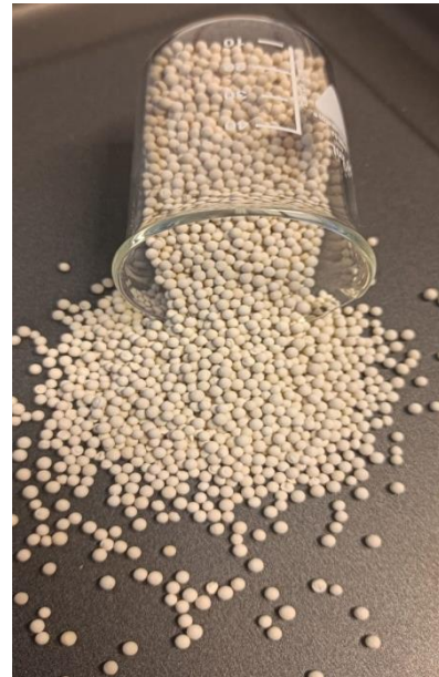
Slika 5. Sintetski zeolit NaX
