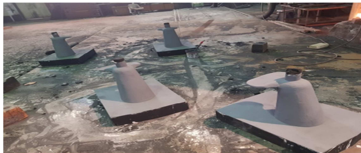
Slika 49. Centralne jezgre za izradu suhog veza [24]
