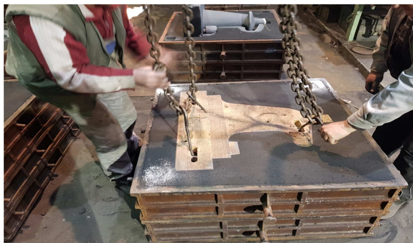
Slika 52. Skidanje drvenih jezgri [24]
