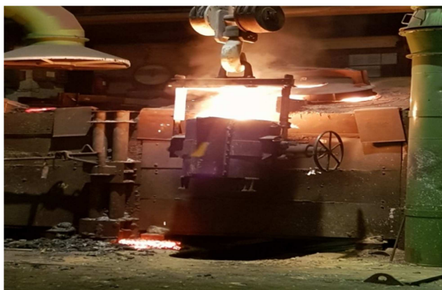
Slika 43. Ulijevanje taline u kotao [24]
