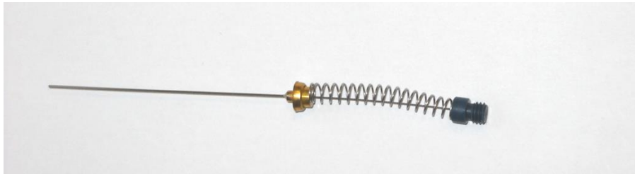
Slika 7. Vlakno sa ovojnicom PDMS/DVB (plavo vlakno)
