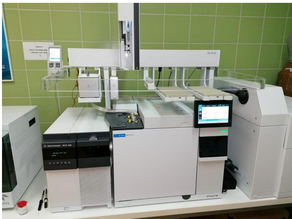
**Slika 17.** Vezani sustav plinska kromatografija-spektrometrija masa (GC-MS)
