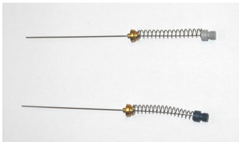
**Slika 16.** Vlakna s ovojnicama DVB/CAR/PDMS (sivo vlakno) i PDMS/DVB (plavo vlakno) (26)
