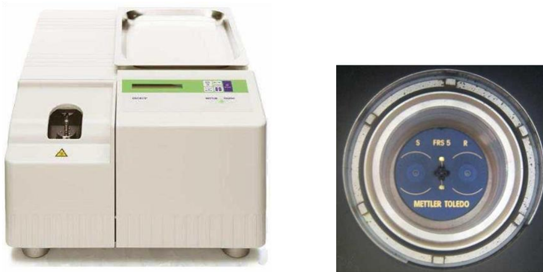
Slika 14. a) Diferencijalni pretražni kalorimetar DSC 823e (MettlerToledo, Švicarska) i b) mjerno osjetilo 37
