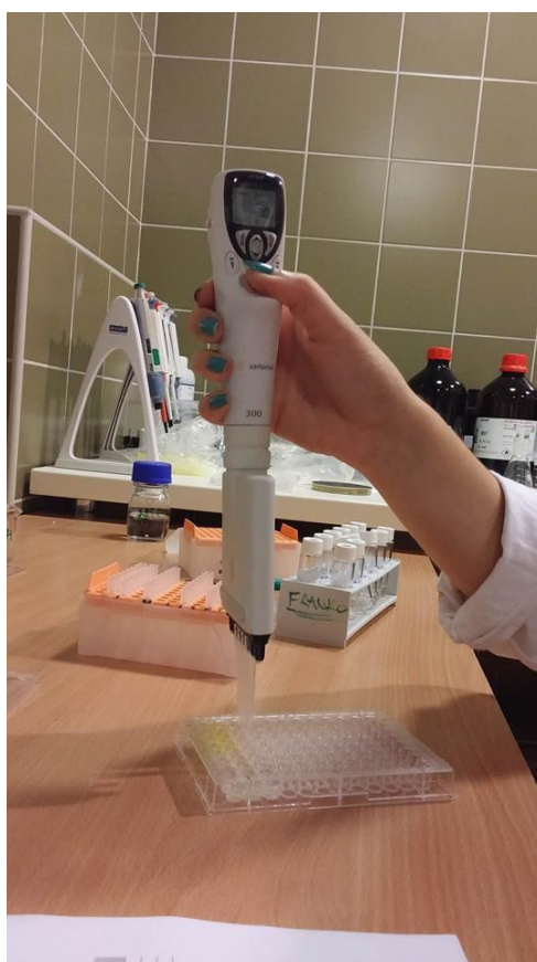
Slika 12. Automatska mikropipeta i otopine različitih koncentracija inhibitora
