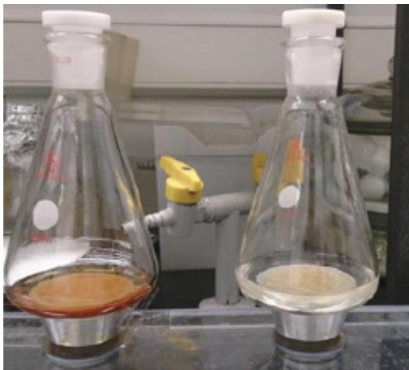
Slika 4. Usporedba eutektičkog otapala dobivenog klasičnom pripravom (lijevo) i ultrazvučno-mikrovalnim reaktorom (desno). [10]
