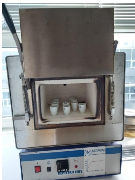
c) Žarna peć ispunjena porculanskim lončićima koji sadrže usitnjeni biljni materijal.
