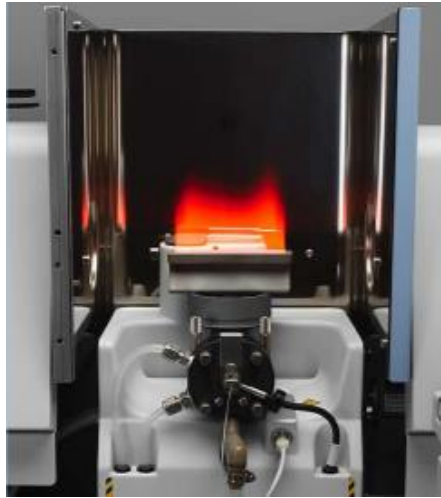
Slika 6. Prikaz atomizacije plamenom. 12
