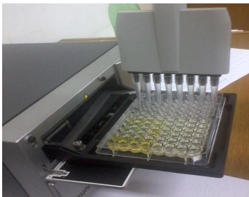
Slika 14. Dodavanje ATChI neposredno prije mjerenja na višekanalnom čitaču mikrotitarskih pločica Sunrise
