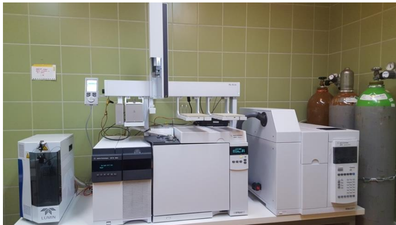
Slika 9. Vezani sustav GC-MS u Zavodu za organsku kemiju Kemijsko-tehnološkog fakulteta u Splitu
