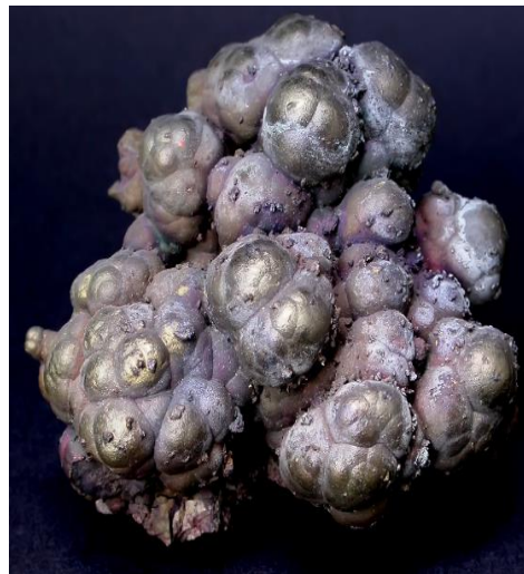
Slika 1.7. Plikasti bakar dobiven iz halkozina 22
