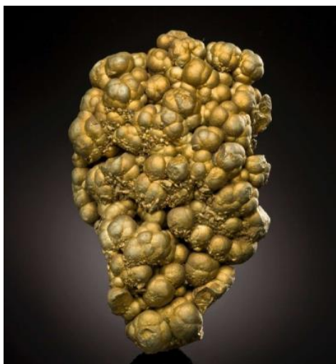
Slika 1.6. Plikasti bakar dobiven iz halkopirita 21
