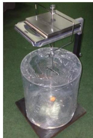
**Slika 8.** Hidrostatska vaga
