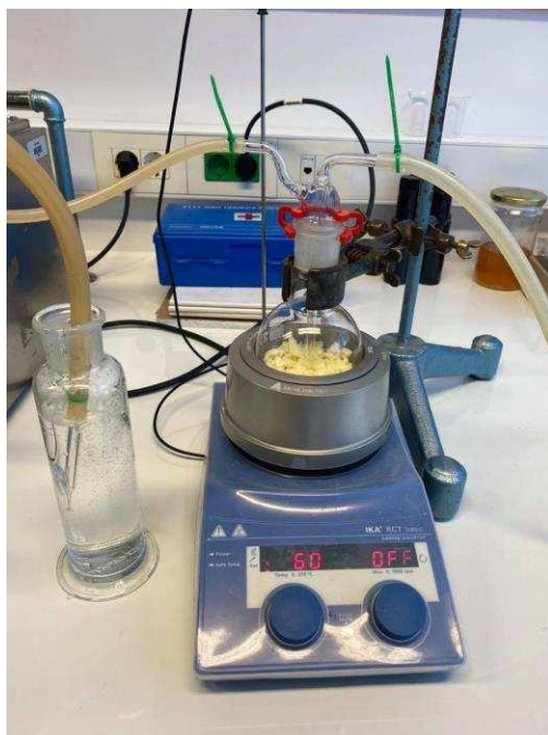
Slika 8. Aparatura za destilaciju sa dušikom i trapovima
