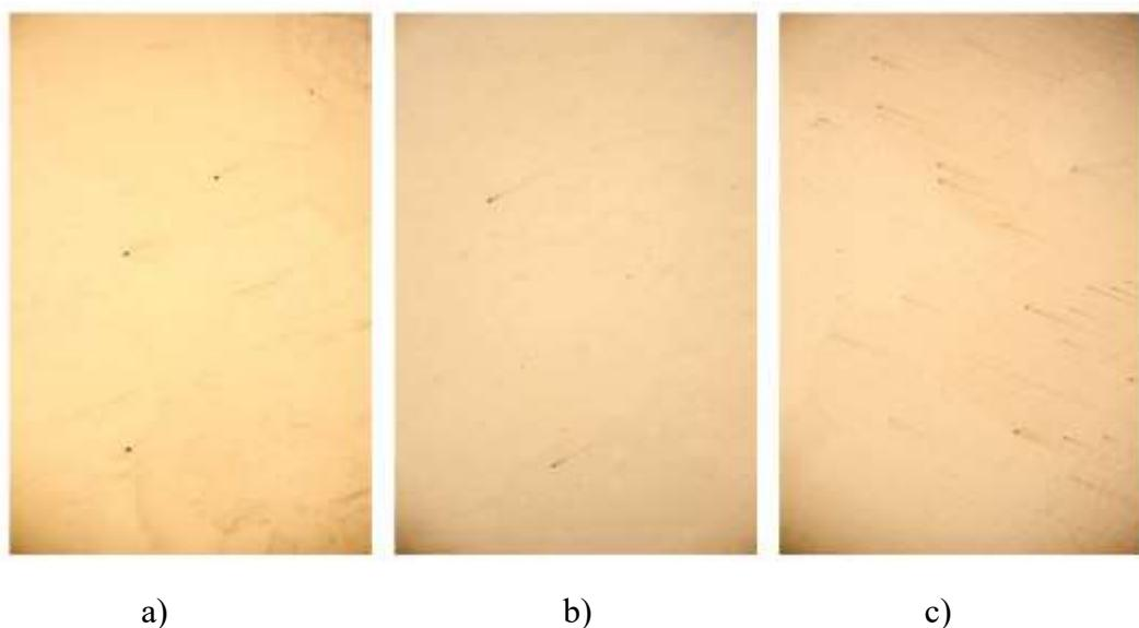
**Slika 3.6.** Mikroskopske snimke površina kositra nakon mjerena u otopinama KI-a različitih temperatura: a)  $10\text{ }^{\circ}\text{C}$ , b)  $20\text{ }^{\circ}\text{C}$  i c)  $30\text{ }^{\circ}\text{C}$
