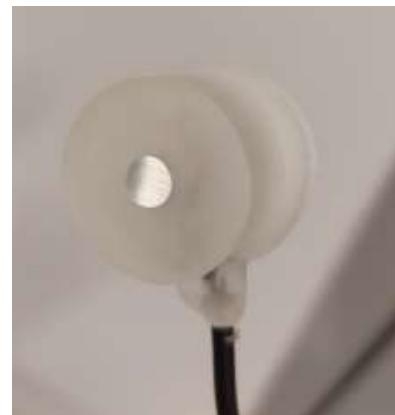
**Slika 2.2.** Elektroda od Sn na kojima su provedena mjerena
