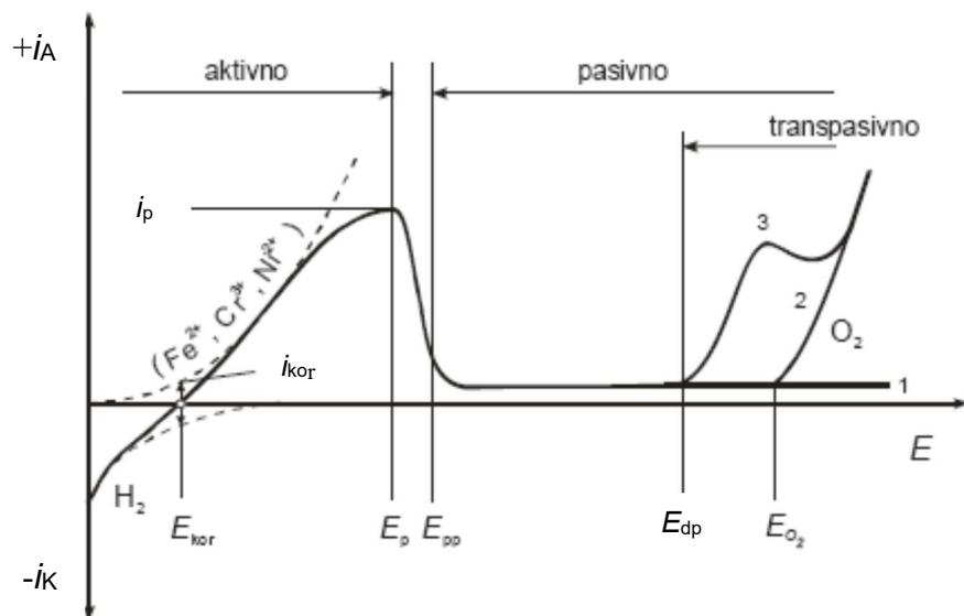
Slika 1.7. Shematski  $i$ - $E$  prikaz pasivacijskog procesa za metale Fe, Ni, Cr<sup>17</sup>
