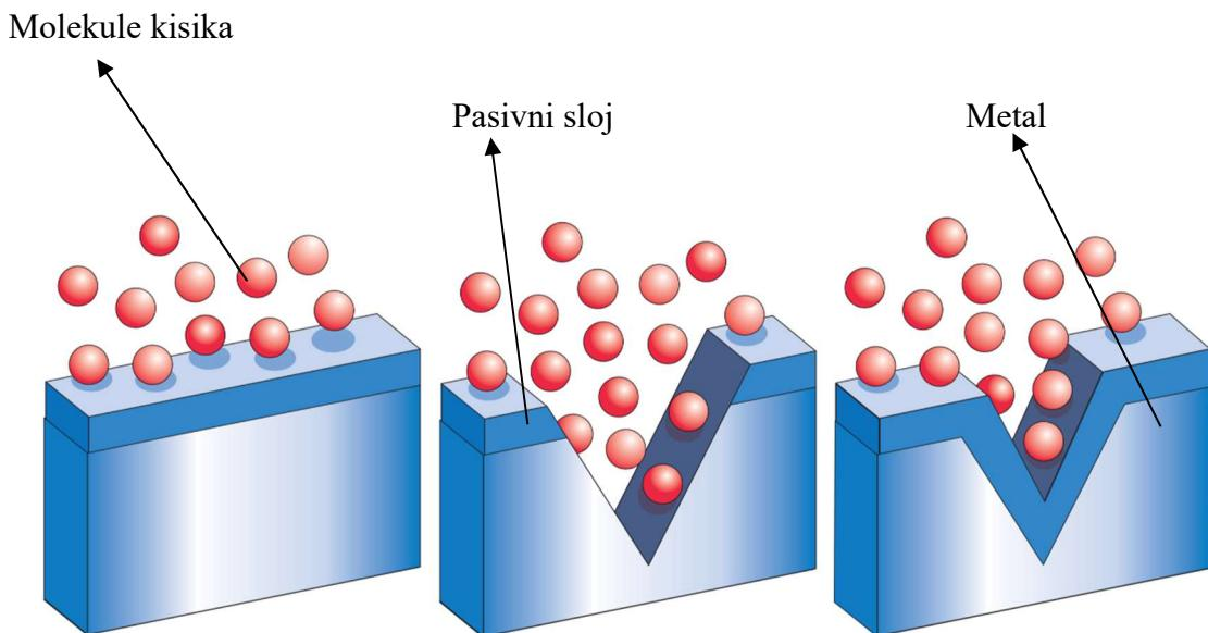
**Slika 1.8.** Prikaz obnavljanja pasivnog sloja na površini metala nakon njegovog oštećenja<sup>19</sup>
