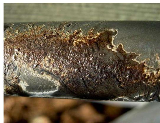
**Slika 1.11.** Prikaz rupičaste korozije na metalnoj cijevi<sup>26</sup>
