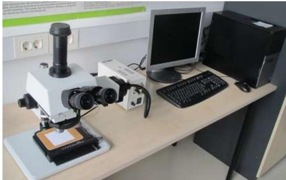
**Slika 2.5.** Optički mikroskop MXFMS-BD, Ningbo Sunny Instruments co.
