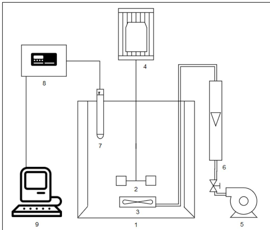
*Slika 14.* Shematski prikaz aparature za provedbu eksperimenta (1. Posuda za raspršenje plina u kapljevini; 2. Miješalo; 3. Raspršivalo plina; 4. Miješalica s regulatorom brzine vrtnje mijesala i mjerilom zakretnog momenta; 5. Puhaljka za zrak s ventilom; 6. Rotametar, 7. Kisikova elektroda; 8. Oksimetar; 9. Računalo).
