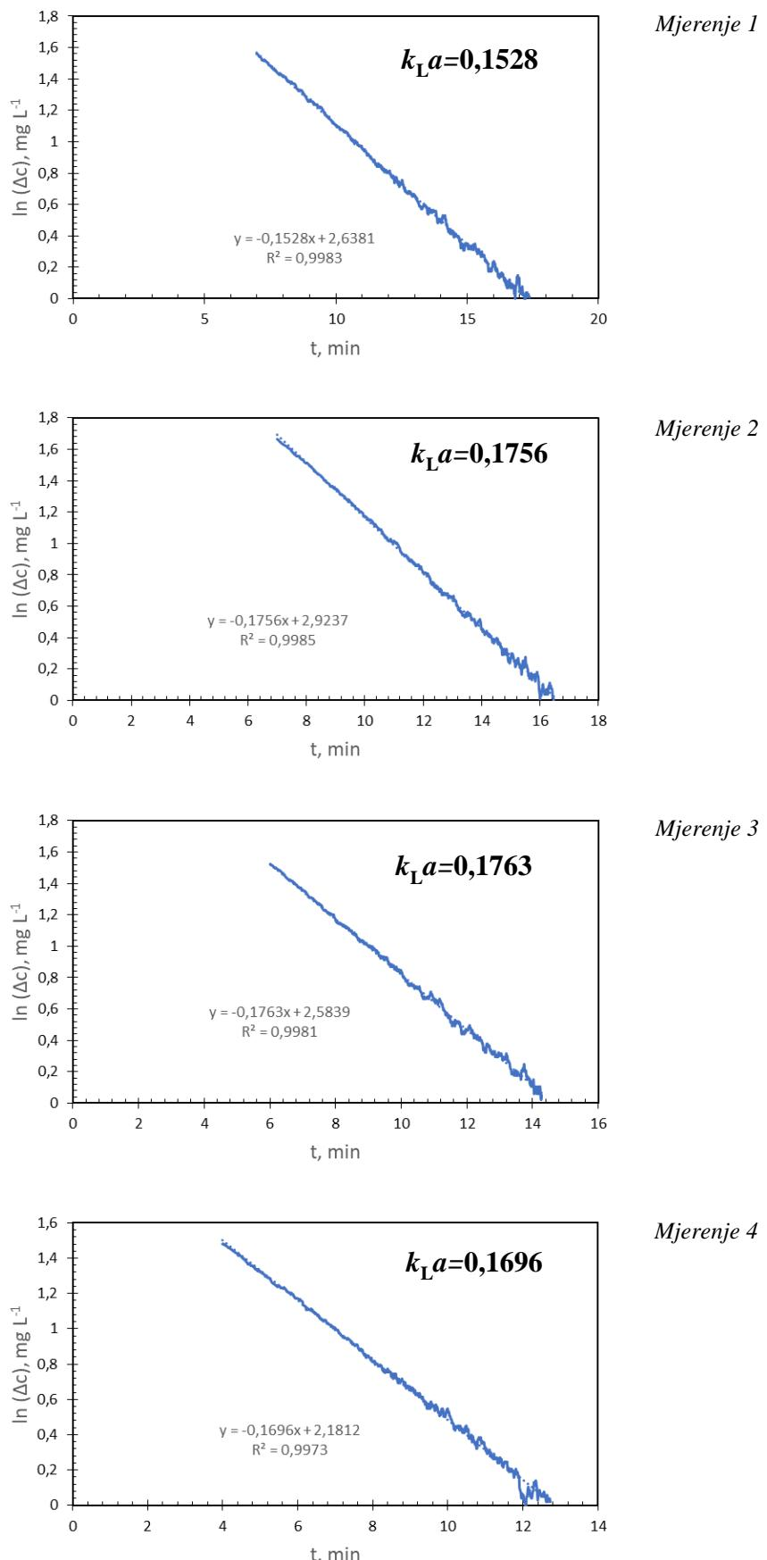
Slika 29. Određivanje vrijednosti  $k_{La}$  korištenjem odabranih podataka promjene koncentracije otopljenog kisika u vodi s vremenom aeracije (TD-6KL,  $Q_g = 200 \text{ dm}^3 \text{ h}^{-1}$ ,  $N_{CD} = 203 \text{ okr. min}^{-1}$ ).
