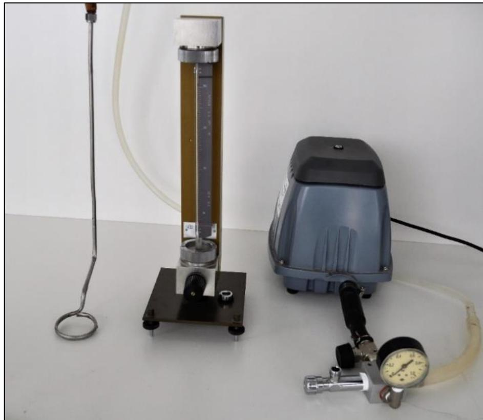
Slika 19. Aparatura za dovod zraka u sustav.
