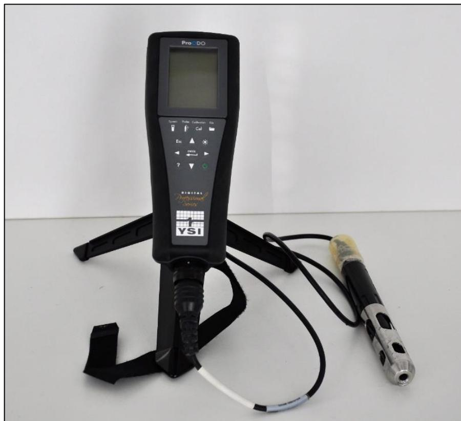
*Slika 20.* Digitalni oksimetar *YSI ProODO* s kisikovom elektrodom.
