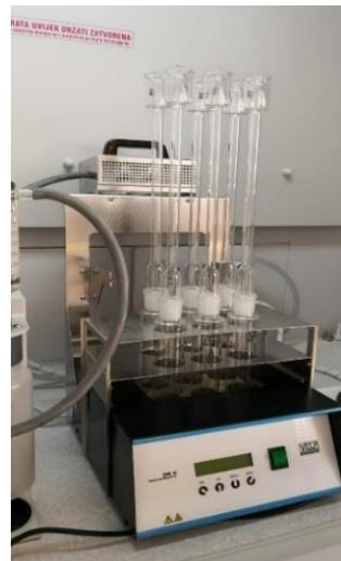
Slika 2.4. Aparatura za određivanje KPK.
