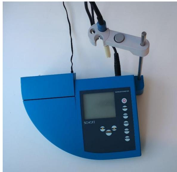
Slika 2.2. Konduktometar tipa Schott korišten u ovom eksperimentu.
