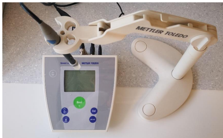
Slika 2.1. pH metar tipa Mettler Toledo korišten u ovom eksperimentu.
