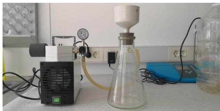
Slika 2.5. Aparatura za filtraciju.
