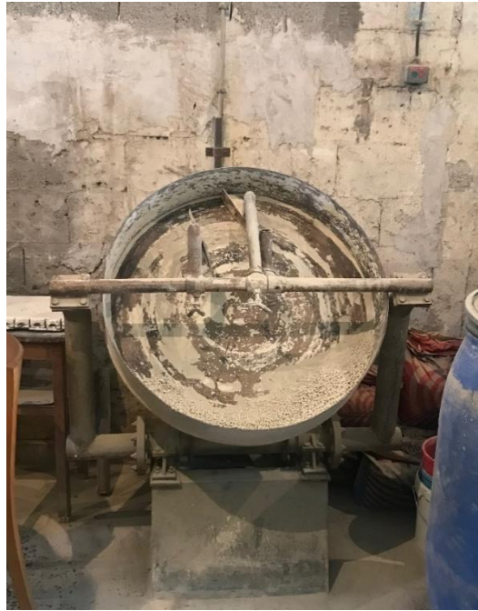
Slika 14. Granulator u poluindustrijskom postrojenju
