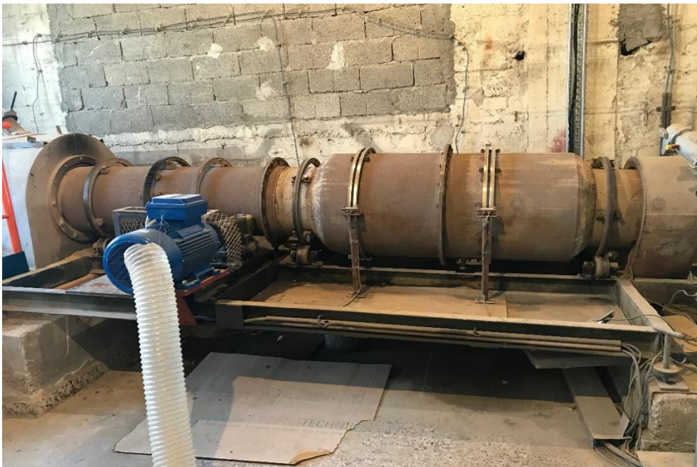
Slika 16. Poluindustrijska rotacijska peć (bočna strana)
