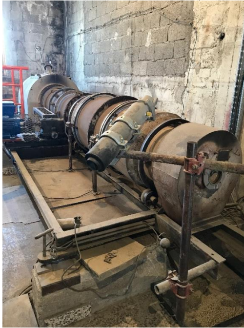
Slika 15. Poluindustrijska rotacijska peć
