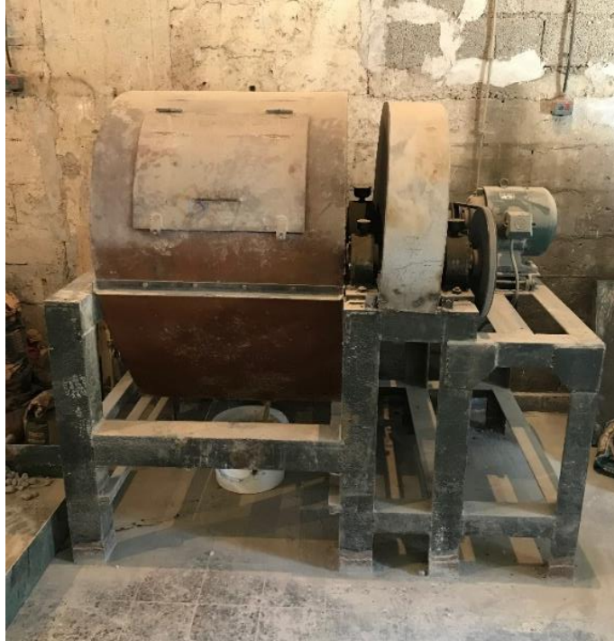
Slika 11. Poluindustrijski horizontalni kuglični mlin
