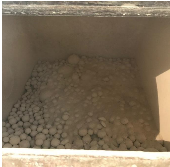
Slika 12. Čelične kuglice u mlinu
