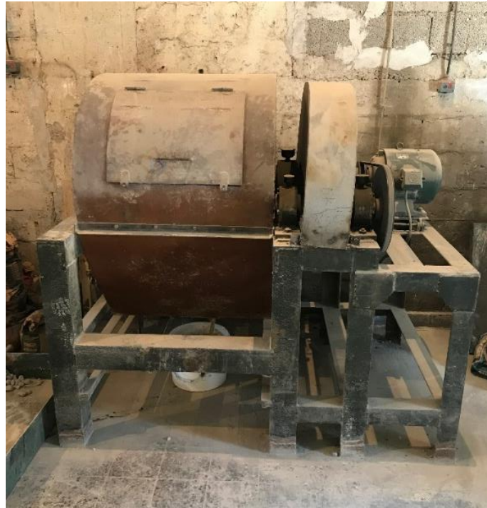
Slika 11. Poluindustrijski horizontalni kuglični mlin
