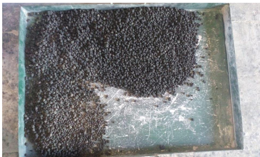
Slika 21. Klinker dobiven pečenjem u poluindustrijskoj rotacijskoj peći
