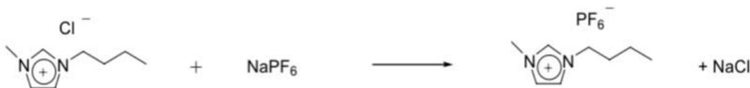
Slika 13. Prikaz sinteze 1-butil-3-metilimidazolijevog heksafluorofosfata reakcijom anionske izmjene između 1-butil-3-metilimidazolijevog klorida s Bronstedovom kiselinom \text{NaPF}_6 . 23
