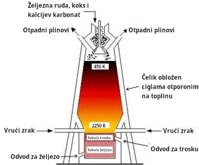
Slika 2.) Shema visoke peći za proizvodnju željeza
