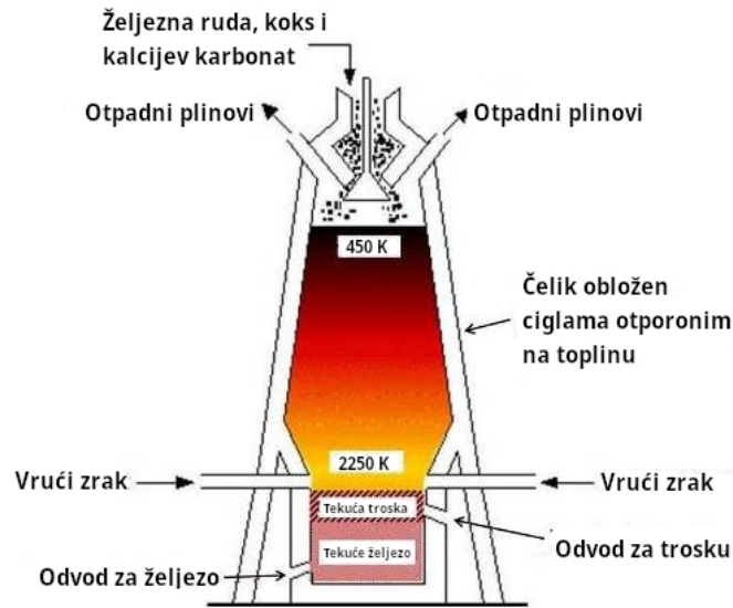
Slika 2.) Shema visoke peći za proizvodnju željeza
