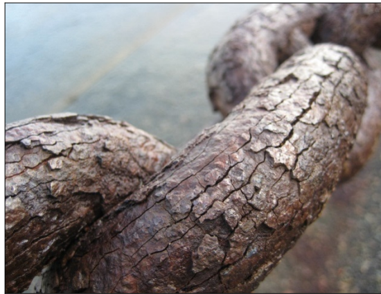
Slika 4.) Korodirani željezni lanac uslijed djelovanja morske vode
