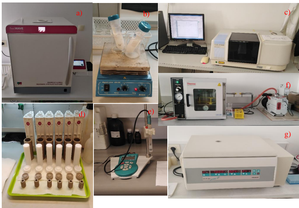
Slika 14: a) mikrovalni reaktor, b) magnetna miješalica, c) FTIR, d) teflonske kivete, e) pH-metar, f) vakuum sušionik, g) centrifuga
