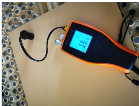
Slika 8. Elcometer 319 mjerač klimatskih uvjeta.
