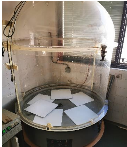
Slika 15. Testne ploče nakon postavljanja u modificiranu slanu komoru.
