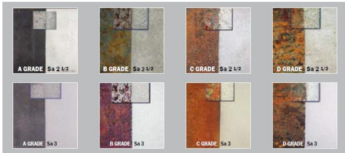
Slika 3. Odstupajuće slike prikazuju razinu korozije, stupnjeve pripreme nezaštićenih čeličnih podloga i čeličnih podloga nakon potpunog odstranjenja prethodnih premaza. 9
