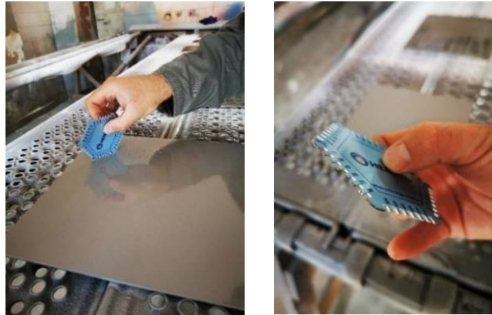
Slika 12. Određivanje debljine mokrog filma pomoću češlja.
