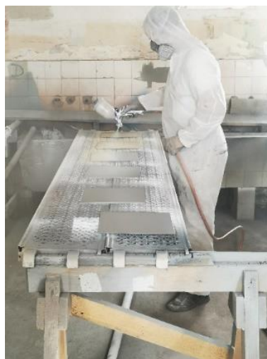
Slika 10. Postupak nanošenja drugog premaza Hempadur quattro 17634/22090.
