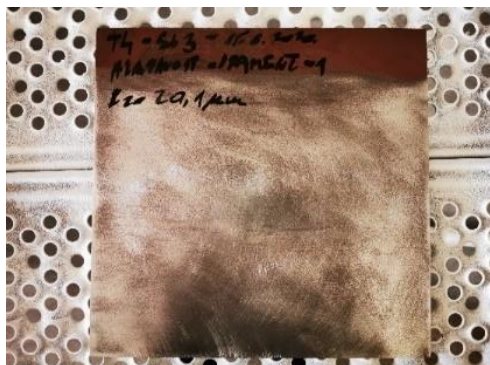
Slika 21. Izgled površine čelične ploče 4 pripravljene prema normi ISO 8504-3:2000, stupanj čistoće St 3.
