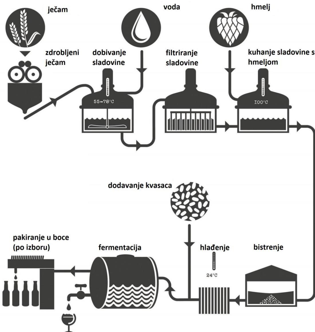
Slika 1. Tehnološka shema proizvodnje craft piva (3)
