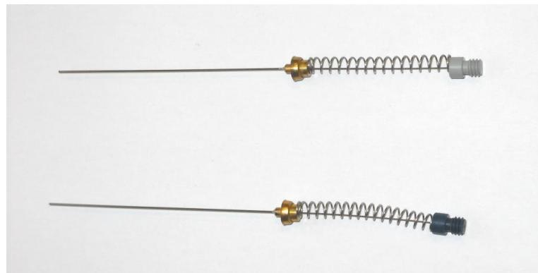
**Slika 7.** Vlakna s ovojnicama DVB/CAR/PDMS (sivo vlakno) i PDMS/DVB (plavo vlakno) (14)
