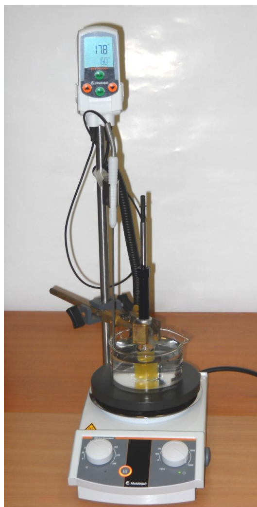
Slika 6. Aparatura za mikroekstrakciju vršnih para na krutoj fazi (HS-SPME) (14)
