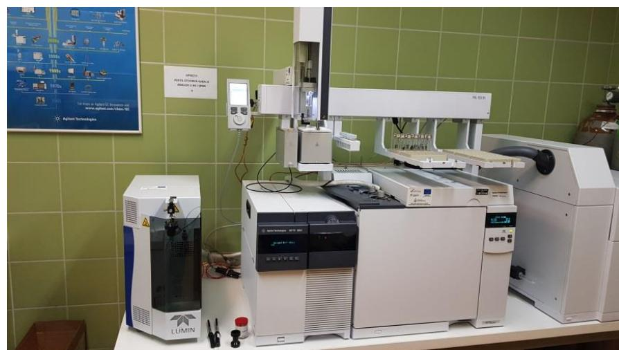
Slika 8. Vezani sustav plinska kromatografija-spektrometrija masa (GC-MS)
