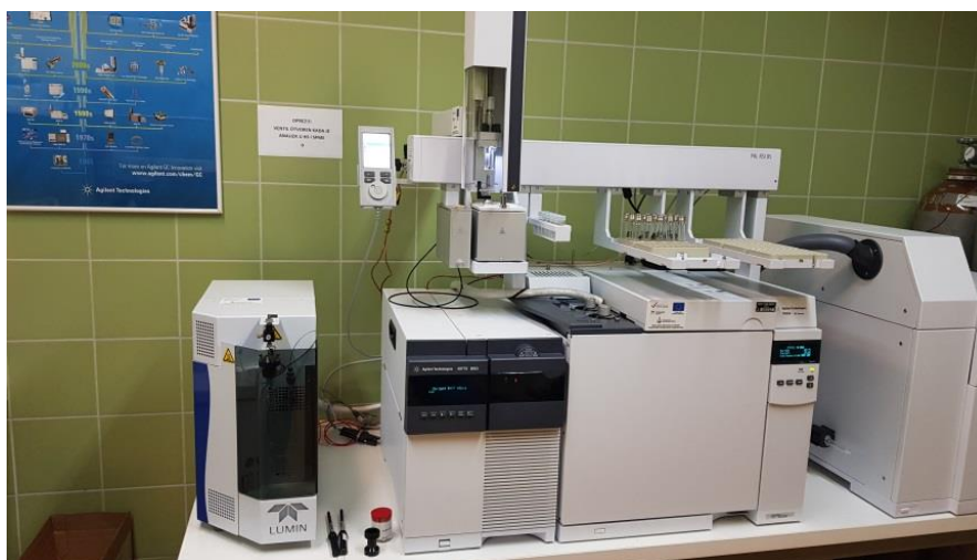
Slika 8. Vezani sustav plinska kromatografija-spektrometrija masa (GC-MS)
