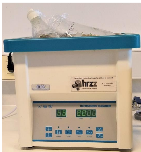
Slika 6. Prikaz provedbe ekstrakcije u UZV kupelji
