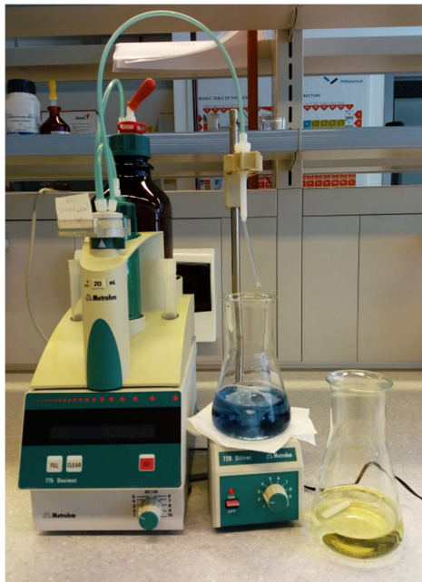
Slika 2.1. Promjena boje pri kompleksometrijskom određivanju olova
