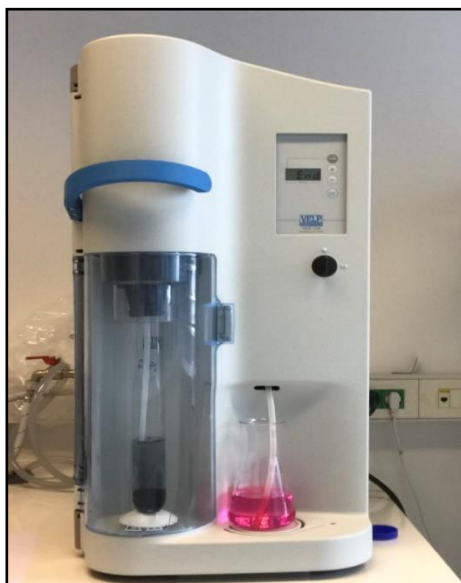
Slika 2.7. Uređaj za destilaciju i određivanje sadržaja dušika metodom po Kjeldahlu
