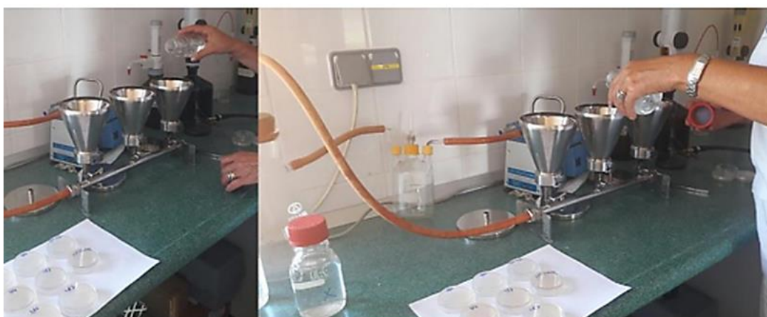
Slika 20. Provedba membranske filtracije pri određivanju koliformnih bakterija.
