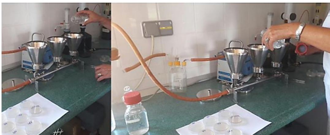
Slika 20. Provedba membranske filtracije pri određivanju koliformnih bakterija.
