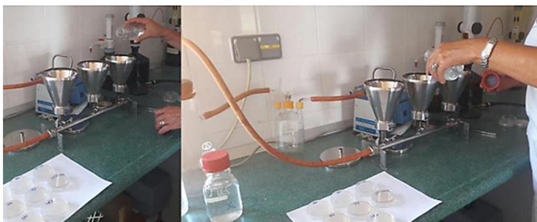
Slika 20. Provedba membranske filtracije pri određivanju koliformnih bakterija.
