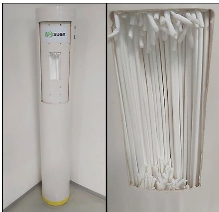
Slika 31. Membranski modul (SKID) sa 60 šupljih vlakana.
