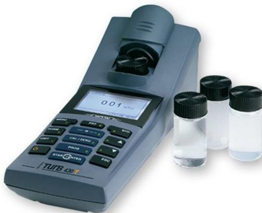
Slika 19. Nefelometrijski turbidimetar tipa WTW Turb 430 IR / SET .
