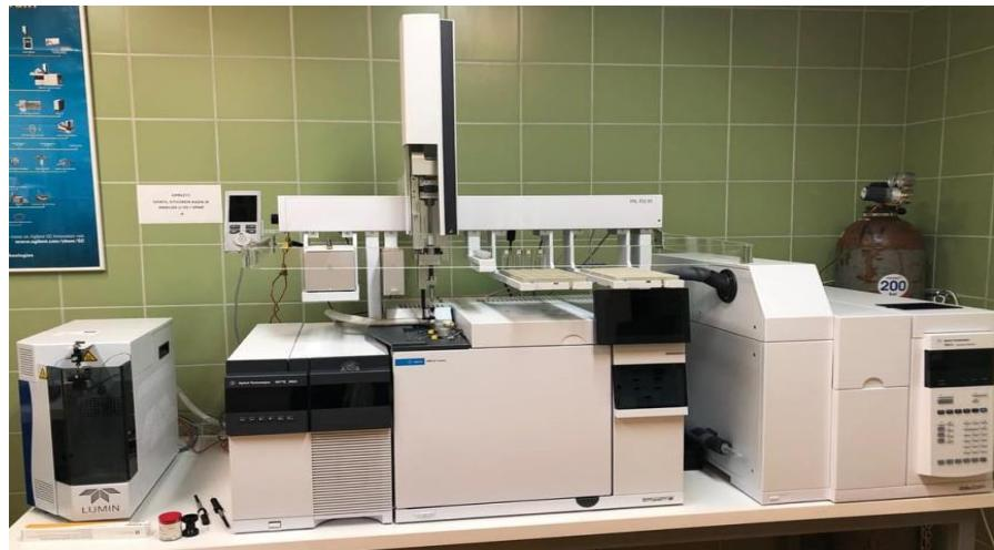
**Slika 15.**Vezani sustav plinska kromatografija i spektrometrija masa (50)
